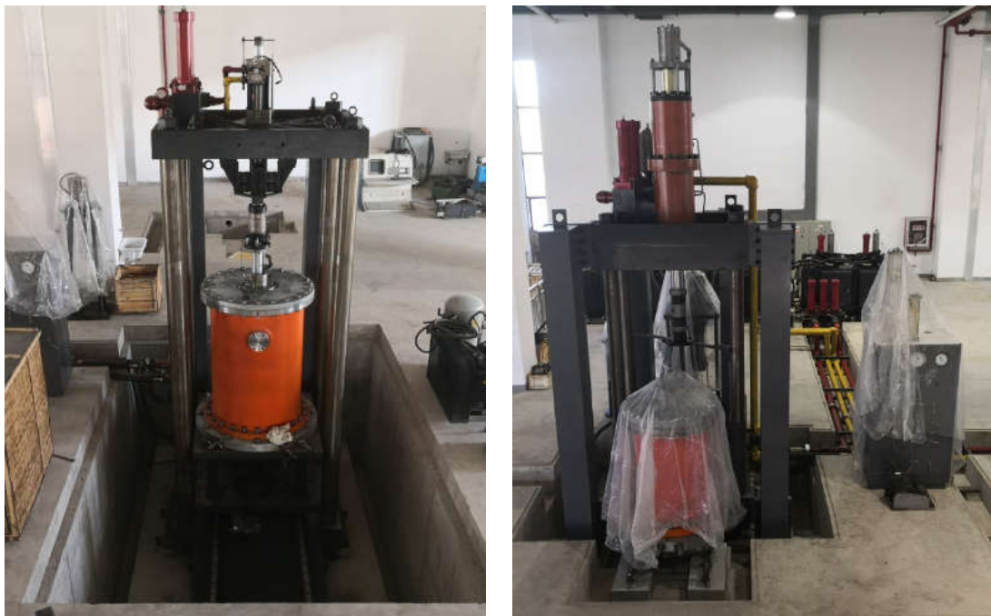
图 2-12 大型高压土工材料试验系统
