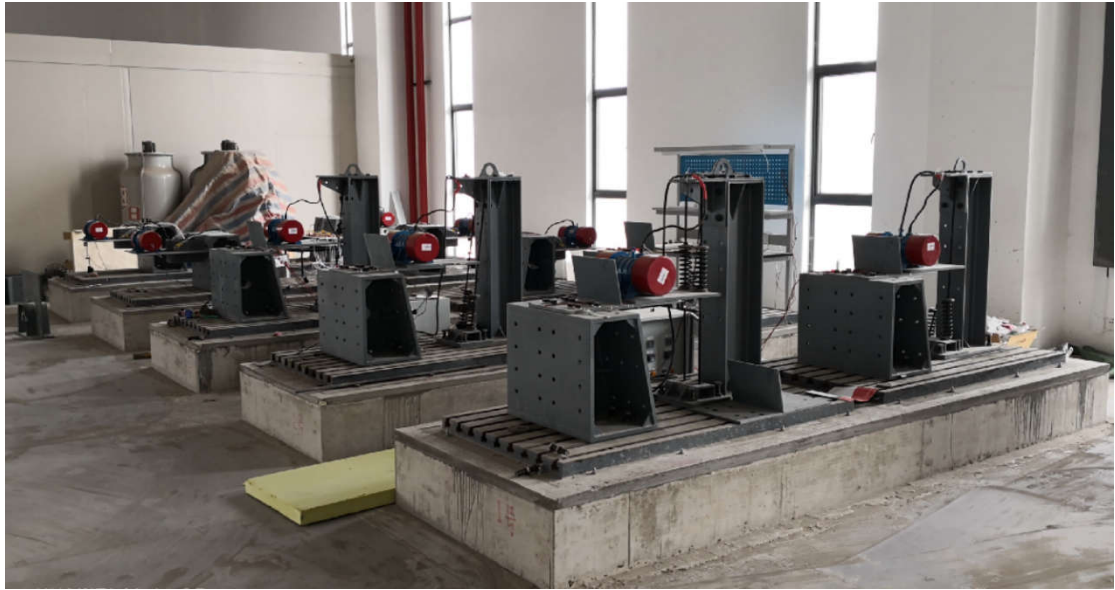
图 2-11 构件疲劳试验系统
