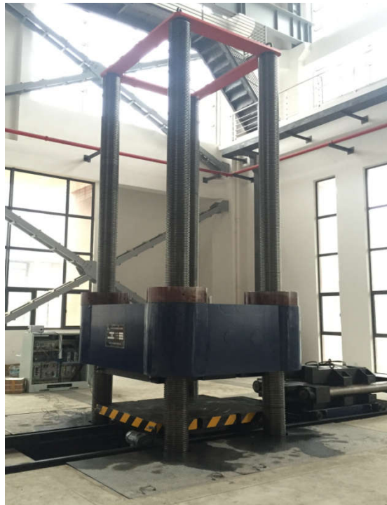
图 2-9 3000 吨级大吨位压剪试验系统
