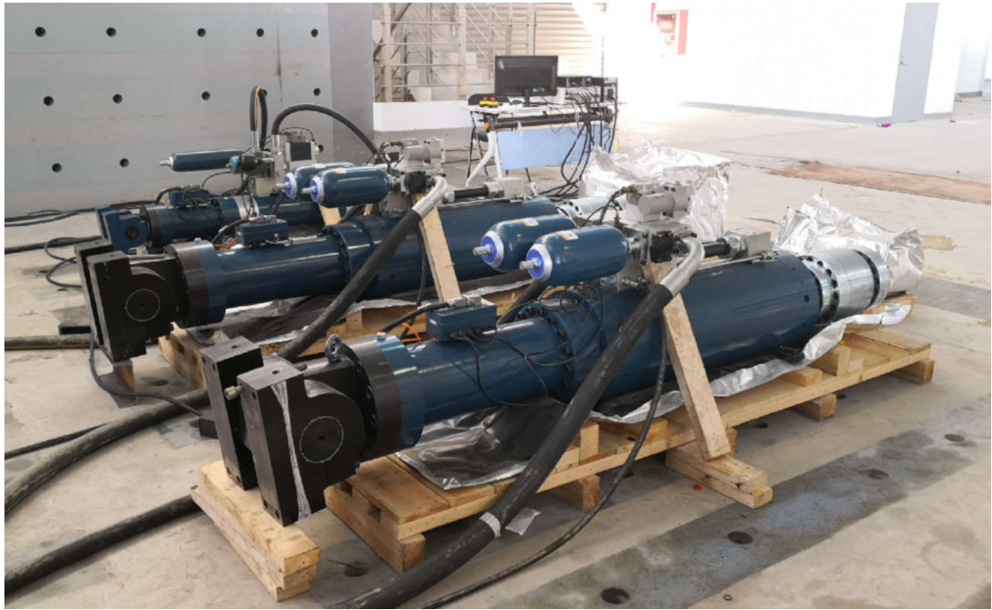
图 2-7 拟动力混合试验系统
