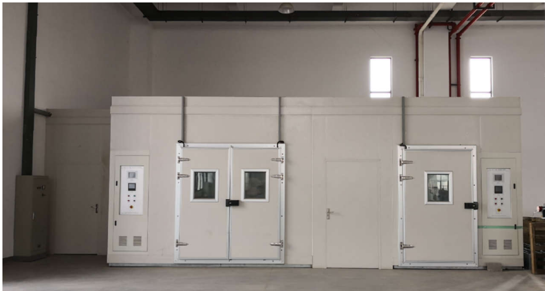
图 2-10 混凝土湿热交替环境试验箱和碳化试验箱
