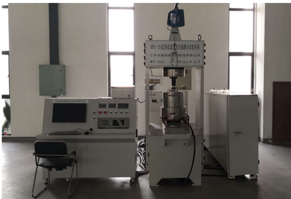
图 2-13 高低温渗透溶蚀耦合试验系统
