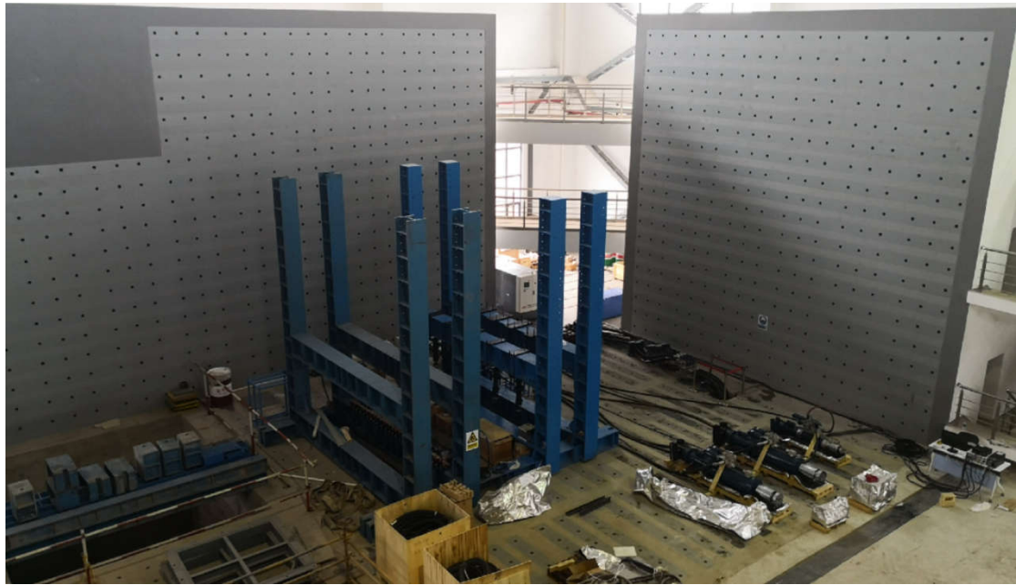
图 2-6 L型反力墙及反力钢架
