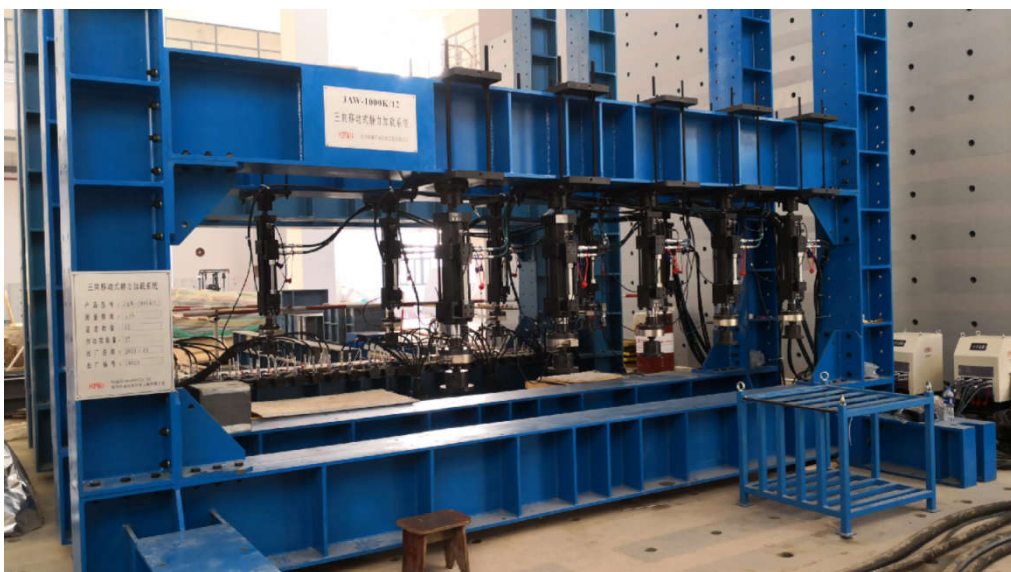
图 2-8 三向移动式静力加载系统
